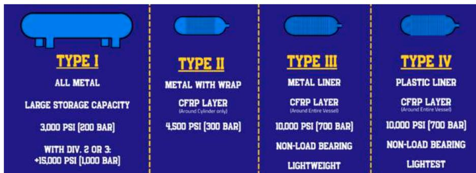
**Figura 6.** Tipos de recipientes de almacenamiento de hidrógeno.
