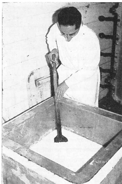
En una de nuestras fabricaciones experimentales el grano en la cuba (original).
