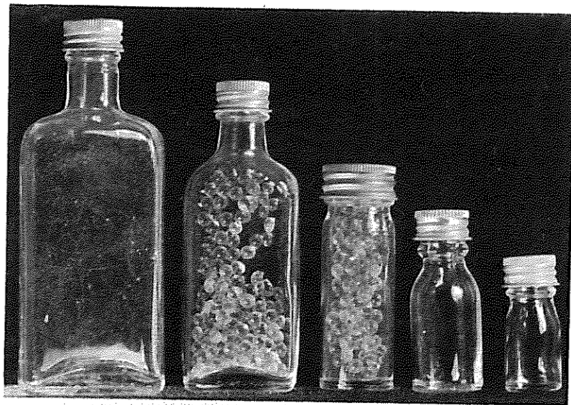
Fig. 1: Botellines y viales Mc Cartney utilizados en las técnicas capilares para la determinación de termorresistencia
